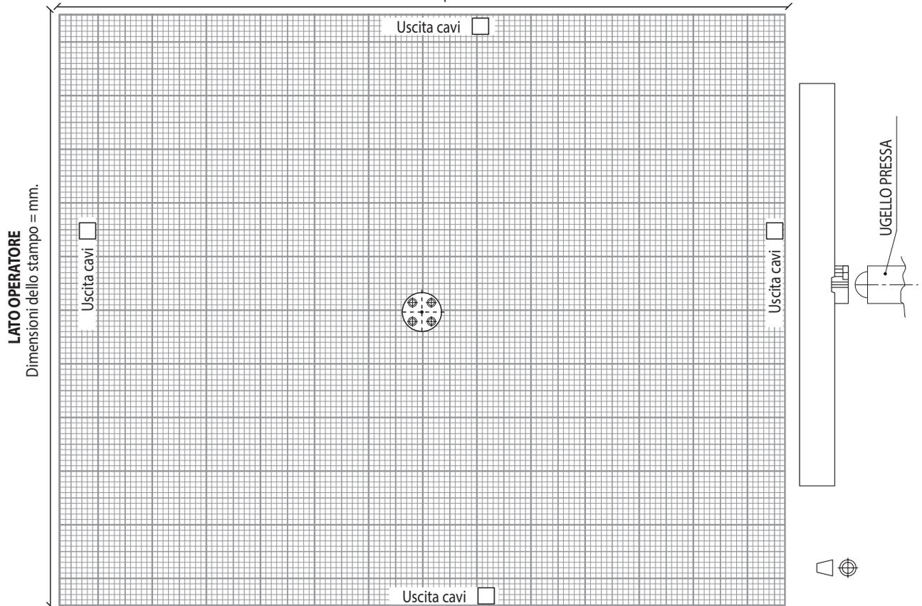
**NOTE: Il disegno in pianta rappresentato è inteso "vista da boccia d'iniezione / ugello pressa".**
